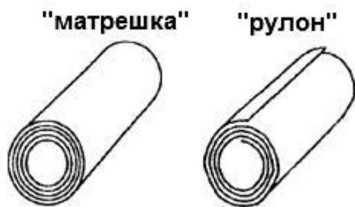
**Рис. 1.9.** Схематическое изображение нанотрубок типов «рулон» и «матрёшка»
