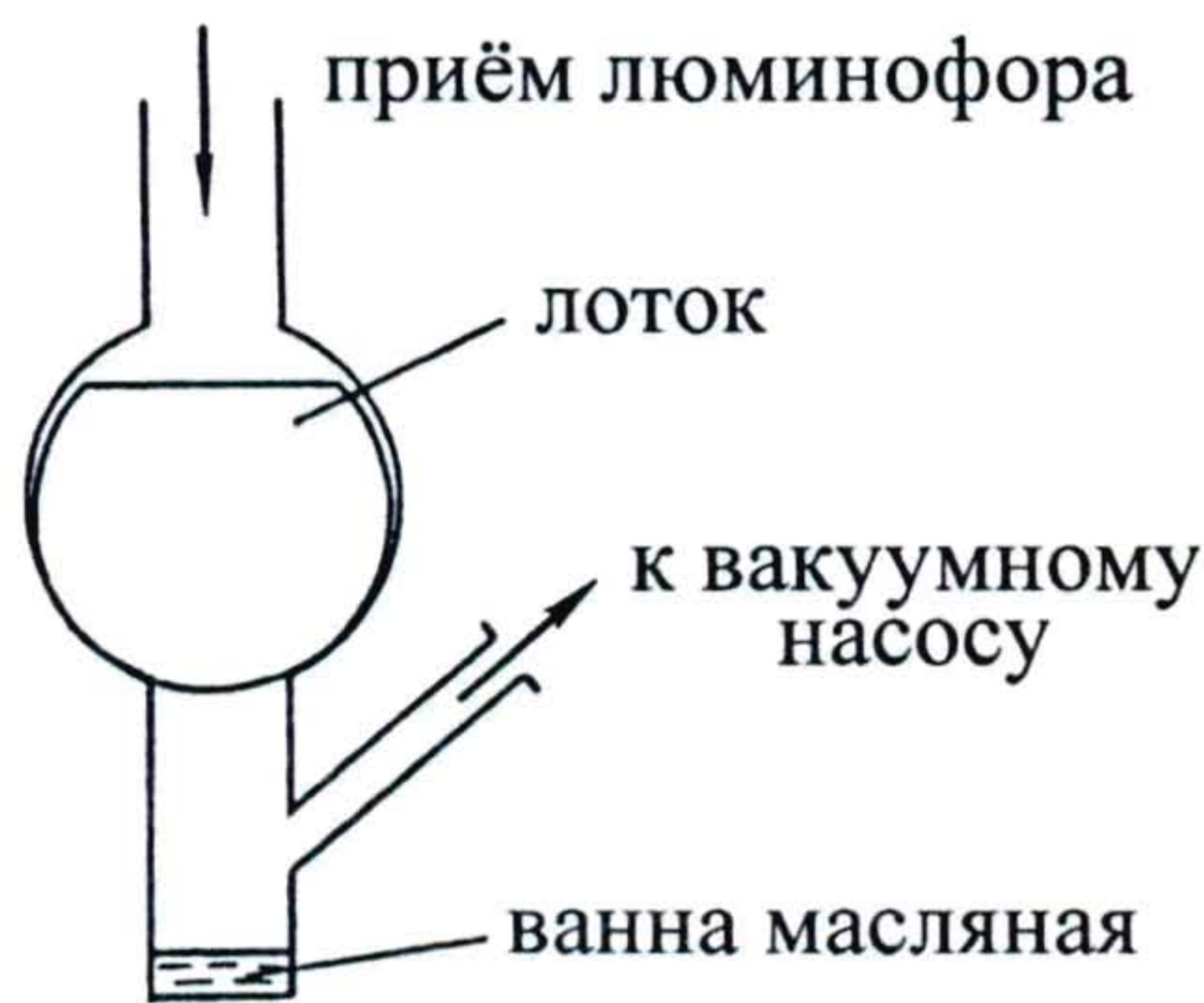
Рис. 3. Схема приёмного бункера вакуумной установки
