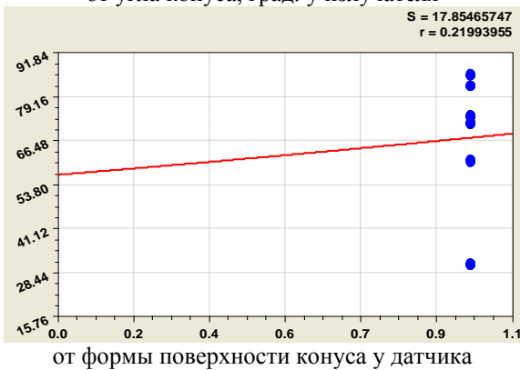
Рис. 3. Графики влияния длины, угла и формы поверхности конусных насадок на время УЗК (в правом верхнем углу графиков показаны сумма квадратов отклонений и коэффициент корреляции)
