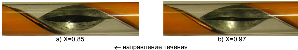
Рис. 2. Эволюция шнуровидных течений в трубе со вставленной скрученной лентой при изменении газосодержания (жидкость подкрашена темной краской; половина сечения канала заполнена резиновой камерой):
