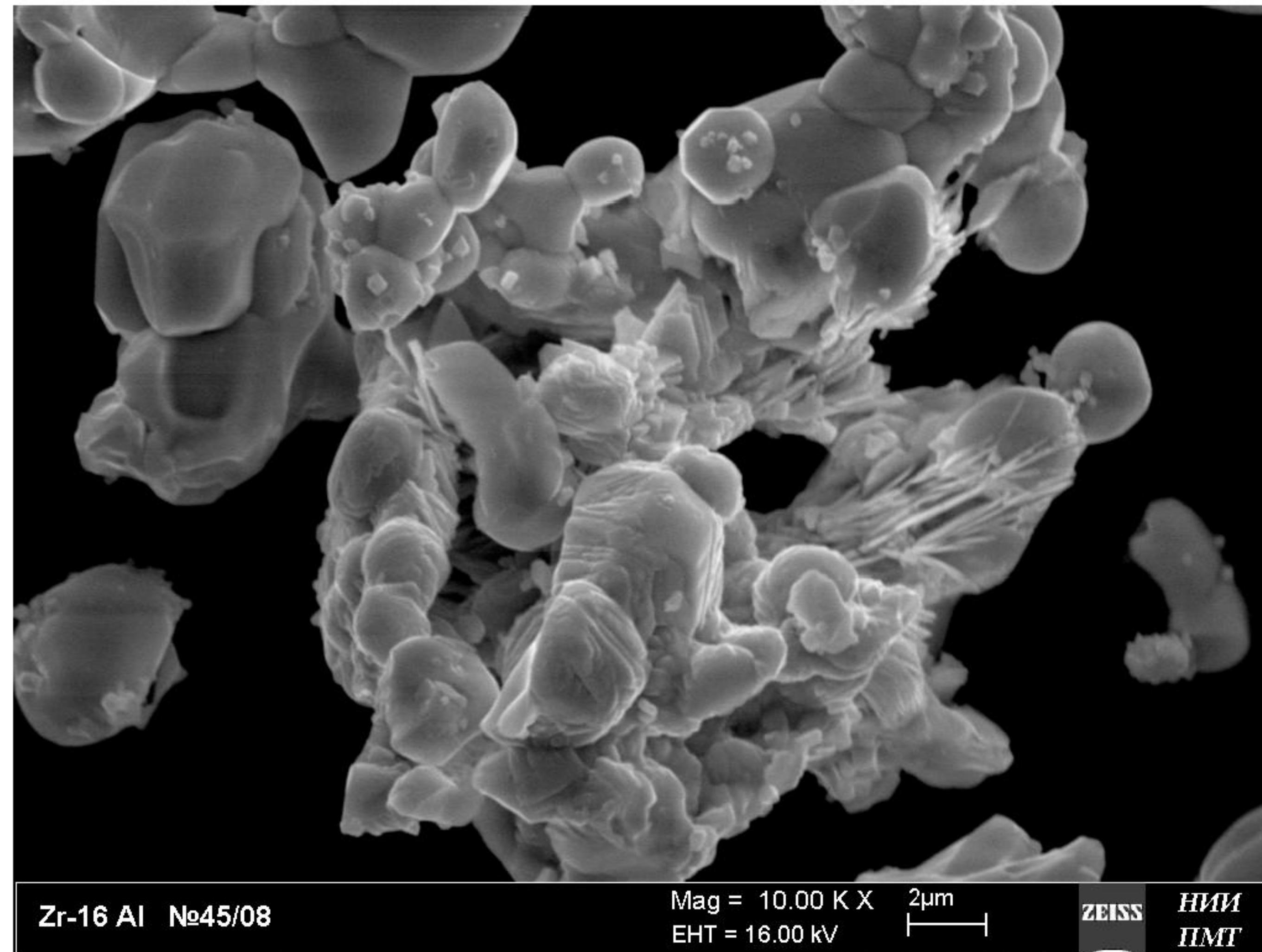
*Рис.2.Наружный вид частиц порошка «Циаль» полученный в растровом электронном микроскопе.*
