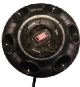
Рис. 2. Встраиваемая платформа с поддержкой до 4-х управляемых каналов с радиостандартом IEEE 802.15.4 в корпусе бытового удлинителя
