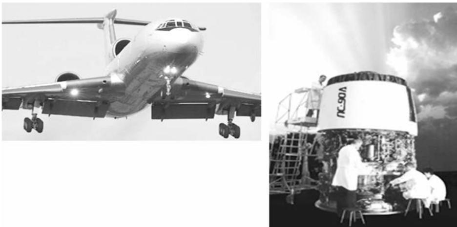
**Рис. 5.2.** После выполнения определенного количества полетов двигатель снимается с самолета и подвергается стендовой разборке
