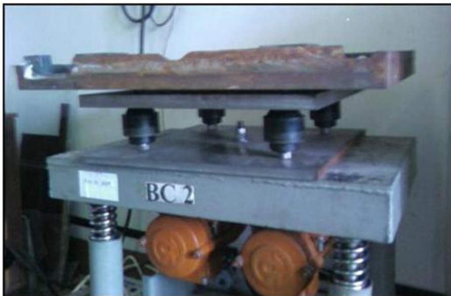
Рис. 1. Фотографии четырёх гидравлических виброопор ОГ-300 под нагрузкой массой в 108,0 кг на вибростенде ЭВ-342.
