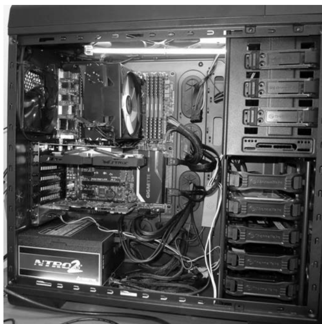
Рис. 1. Стенд для исследования эффективности решения прикладных задач с параллельными вычислениями на ПЛИС, CPU, GPU
