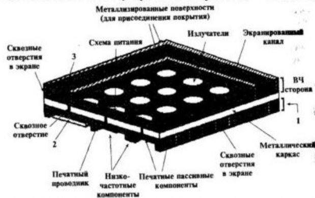
Рис. 3. Интегральный приемопередающий LTCC-M модуль.
