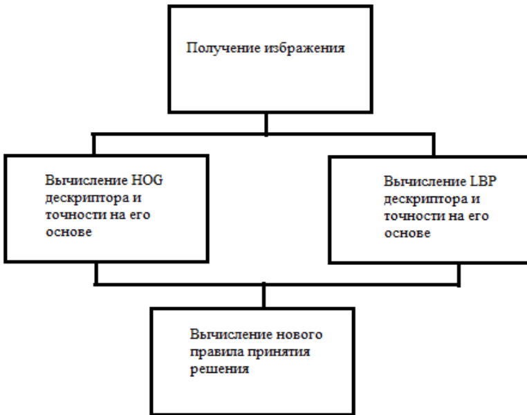
Рис. 3. Схема работы адаптивного алгоритма на основе дескриптора HOG и LBP
