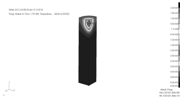
Рис. 1. Распределение температур в ледяном цилиндре при полном погружении нагретого шара в лед (4 шаг моделирования)
