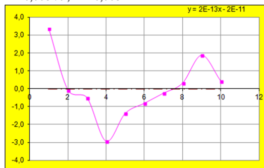
Рис. 2. Случайная погрешность с исключенным дрейфом на мере X1 0 =1130,13 мкм
