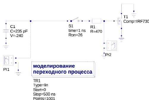
Рис. 2. Схема модели воздействия НВМ ЭСР на транзистор IRF730.
