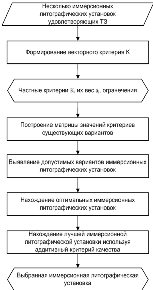
Рис. 1. Алгоритм выбора лучшей иммерсионной литографической установки по критерию К
