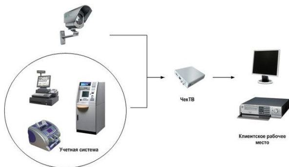
Рис. 1. Принцип работы системы событийного видеоконтроля в банке
