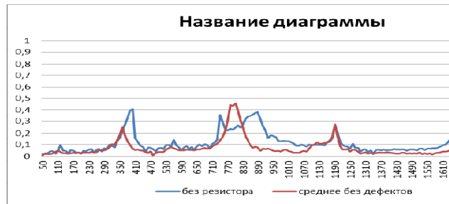
Рис. 4. АЧХ печатной платы с дефектом: отсутствие резистора.
