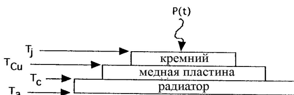
Рис. 1. Схематическое изображение многослойной системы отвода тепла от мощного элемента.
