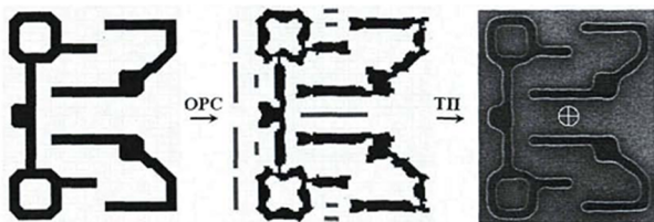
Рис. 4. Фрагмент исходной топологии и фрагмент после травления
