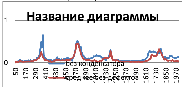
Рис. 5. АЧХ печатной платы с дефектом: отсутствие конденсатора.
