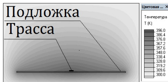
Рис. 6. Распределение теплового поля в плате при токе 0,7 А.
