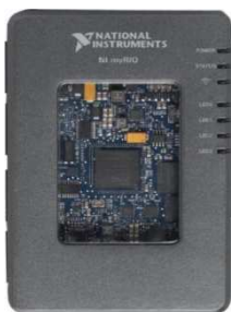
Рис. 2. Устройство MyRIO от National Instruments
