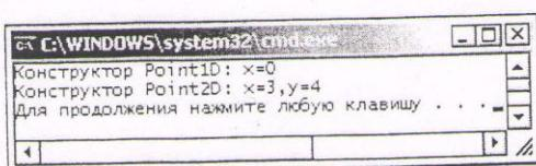
Рис. 2. Последовательность вызовов конструкторов базового и производного классов
