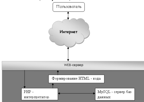
Рис. 2. Логическая структура ИС
