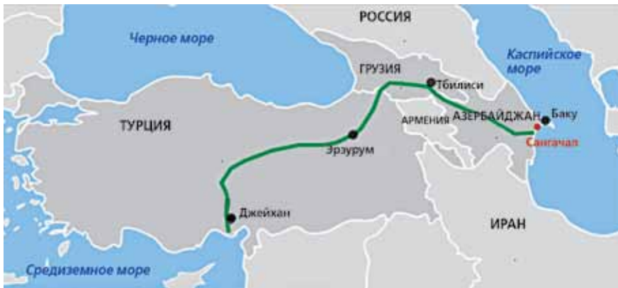
Рисунок 3. Нефтепровод Баку–Тбилиси–Джейхан был создан для поставок нефти Каспийского моря до Средиземноморского берега Турции (порт Джейхан)
