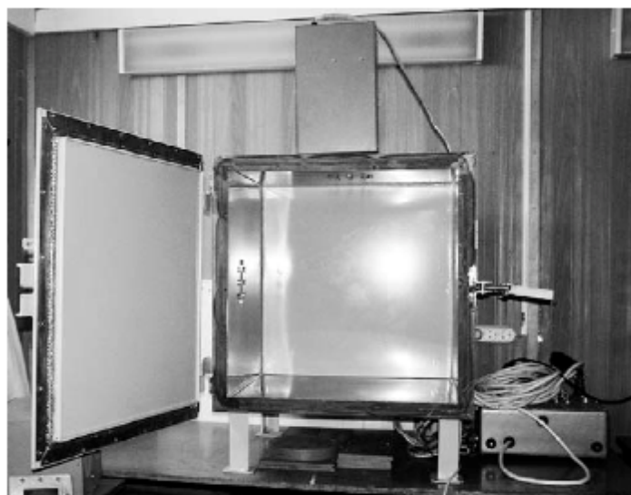
Рис. 3. СВЧ установка для проведения экспериментальных исследований распределения температуры по объему материала
