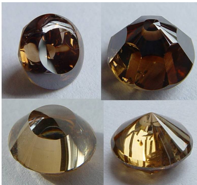
Рис.3 Сформированные конфигурации поверхности алмаза, описываемые уравнениями второго порядка.
