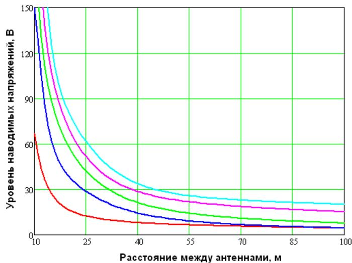
Рис. 4. Зависимость уровня наводимых напряжений от расстояния между взаимодействующими антеннами при различных мощностях радиопередающего устройства
