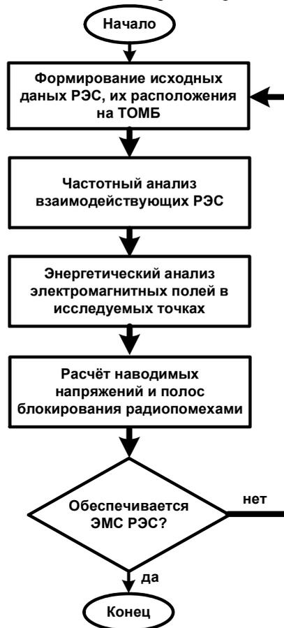
Рис. 5. Укрупнённая структура алгоритма программной реализации методики расчёта ЭМС РСС
