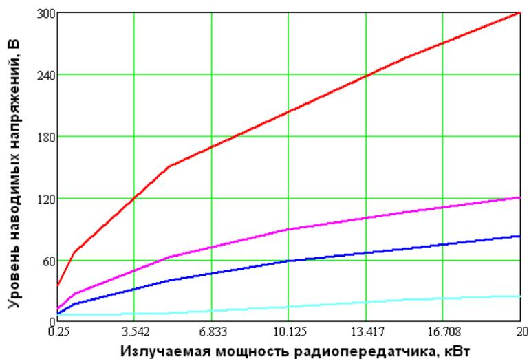
Рис. 3. Зависимость уровня наводимых напряжений от мощности радиопередаточного устройства при различных расстояниях между взаимодействующими антеннами
