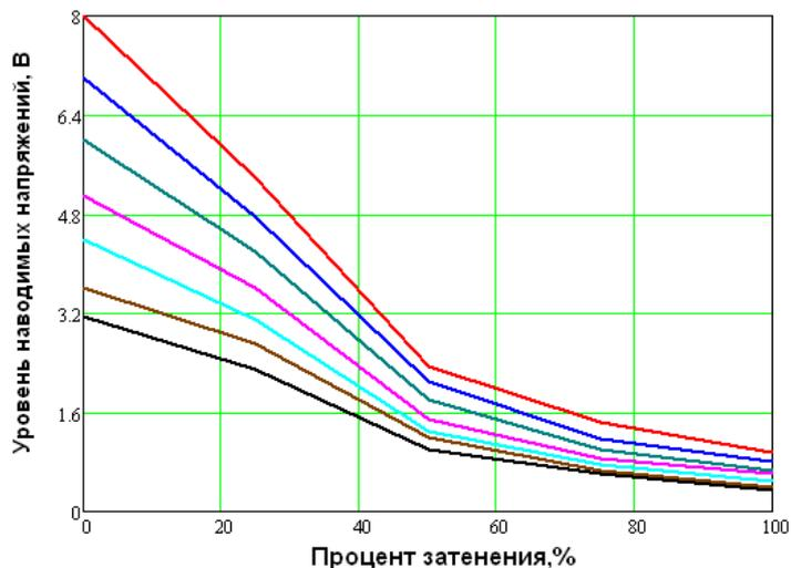
Рис. 2. Зависимость уровня наводимых напряжений от процента затенённости препятствиями между взаимодействующими антеннами для различных значений мощности радиопередаточного устройства
