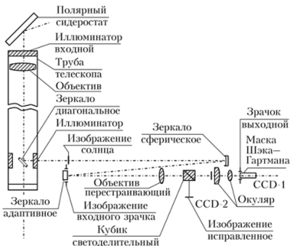
Рис. 2. Оптическая схема БСВТ с элементами адаптивной оптики
