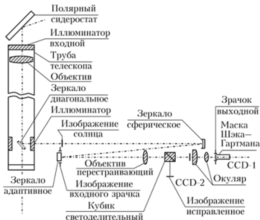
Рис. 7. Оптическая схема БСВТ с элементами адаптивной оптики.
