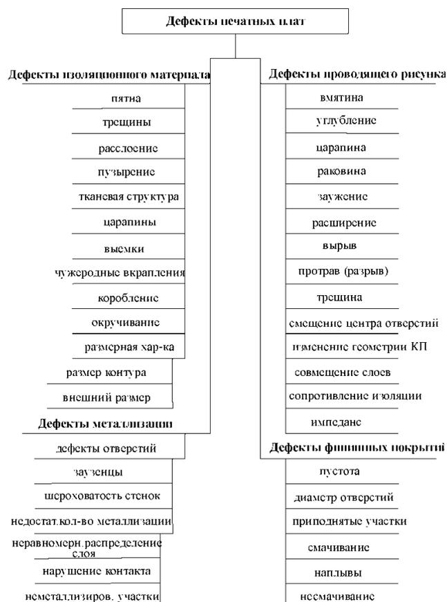
Рис. 1. Классификация технологических дефектов печатных плат
