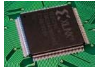
Fig. 6. Integrated microcircuit type «XC2C128-TQ144»
