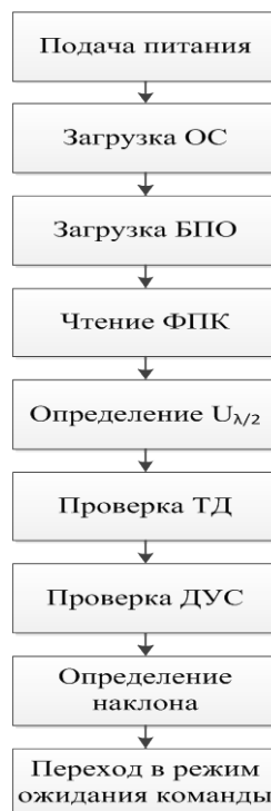
Рисунок 4 – Блок схема включения и выполнения режима самодиагностики
