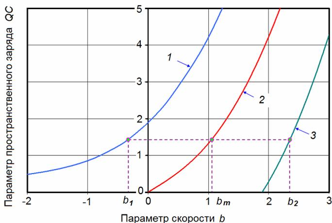
Рис. 3. Зависимости между параметром скорости  $b$  и соответствующим ему значением параметра пространственного заряда  $QC$  на первой и второй границах области взаимодействия (кривые 1 и 2, соответственно); кривая 3 относится к режиму максимального взаимодействия
