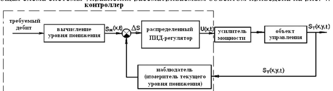
Рис 4. Схема системы управления
