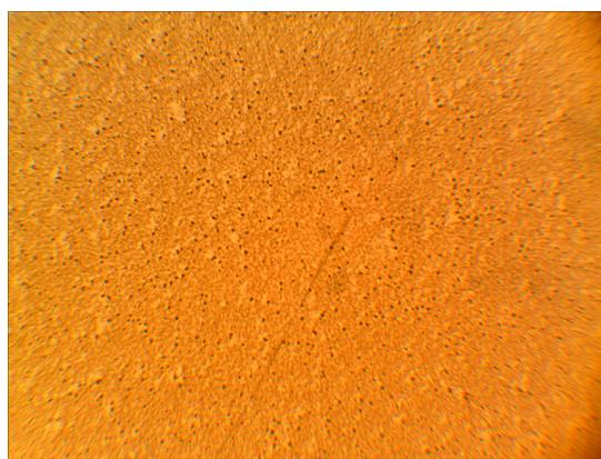
Рисунок 5. Определение нестабильности смеси нефтей, перерабатываемой на НПЗ, по ГОСТ Р 50837.5-95 «Топлива остаточные. Определение прямогонности. Метод определения числа пептизации» при добавлении 1 мл цетана.
