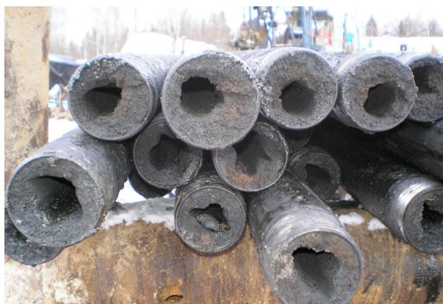
Рисунок 2. Асфальтено-смолисто-парафиновые отложения на стенках трубопровода
