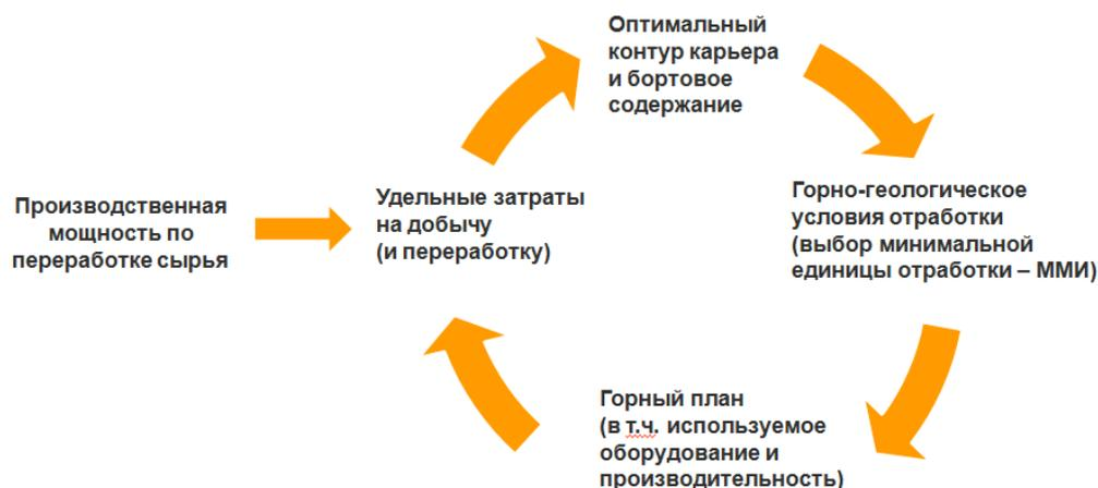
Рис. 1. Взаимосвязь параметров оптимизации горных работ при проектировании
