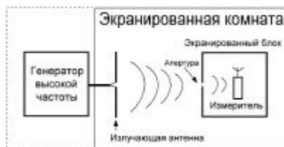
Рис. 2. Схема проведения измерения поля внутри экранированного блока
