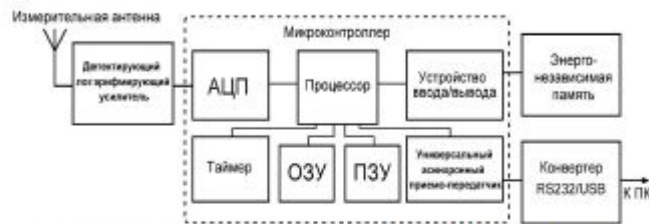
Рис. 3. Структурная схема измерителя напряженности поля
