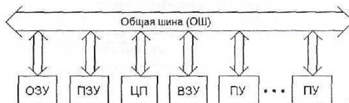
Рис. 2. Структурная схема ЭВМ с общей шиной
