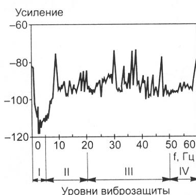
Рис. 3. Спектр вибраций при отсутствии системы виброзащиты
