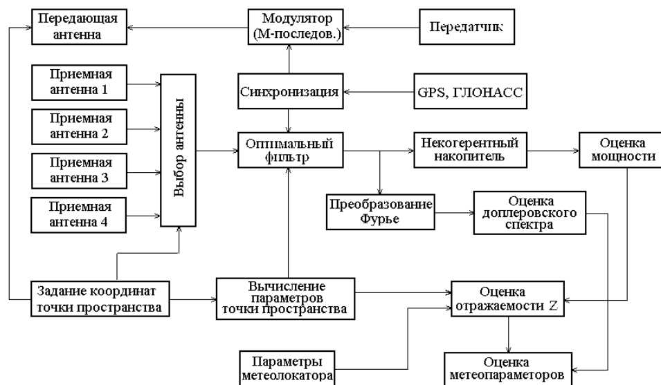
Рис. 2. Функциональная схема метеолокатора
