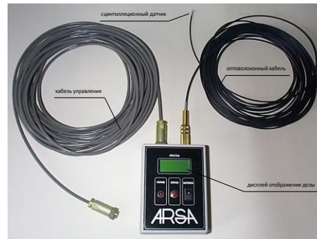
Рис. 6. Волоконно-оптический монитор-дозиметр, совмещенный с пультом управления ускорителя АРСА
