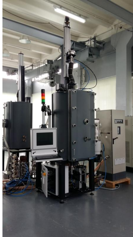
Рис. 1. Промышленная установка «НИКА-ПРОФИЛЬ 10» для выращивания профилированных кристаллов сапфира
