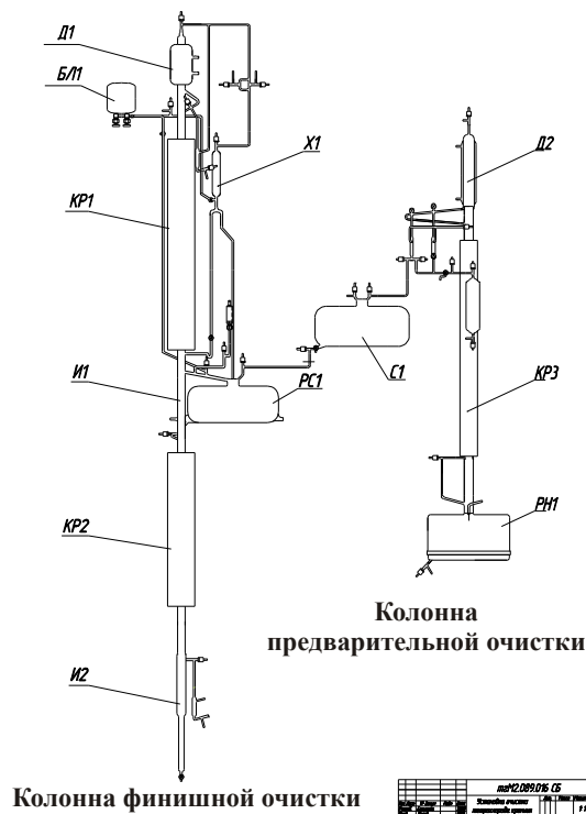
Рис. 1. Схема ректификационного комплекса для получения высокочистого тетрахлорида кремния: Д1, Д2 – дефлегматоры; КР1, КР2, КР3 – разделительные секции; И1, И2 – испарители; БЛ1 – баллон; Х1 – холодильник; С1 – промежуточная емкость; РС1 – средний питающий резервуар; РН1 – нижний куб.
