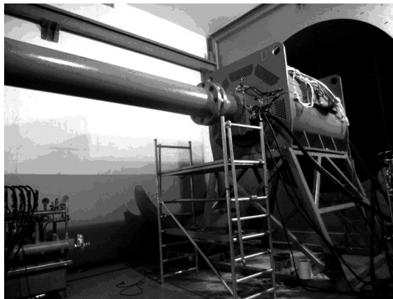
Рис. 3. Вентилятор диаметром 5300 мм и мощностью 10 МВт в процессе монтажа в аэродинамической лаборатории компании ZITRON для последующих аэродинамических испытаний
