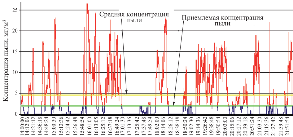
Рис. 3. Изменение концентрации пыли (записано с помощью пылемера РЛ-2, расположенного в 60 м от лавы)
