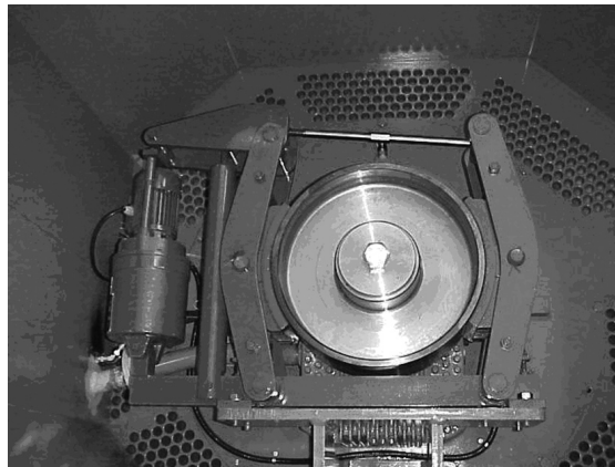
Рис. 2. Сборочный узел вентилятора, показанного на рис. 1, с расположенным на втором конце вала электродвигателя гидравлическим стояночным тормозом
