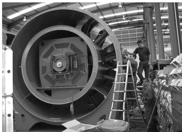
Рис. 1. ВГП со встроенным электродвигателем в процессе монтажа на сборочном участке № 1 в цеху компании ZITRON
