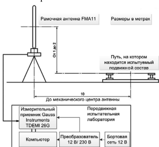
Рис. 4. Позиция антенны при измерении магнитного поля в диапазоне частот от 150 кГц до 30 МГц
