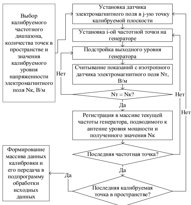
Рис. 3. Алгоритм функционирования измерительной системы в режиме «Калибровки»
