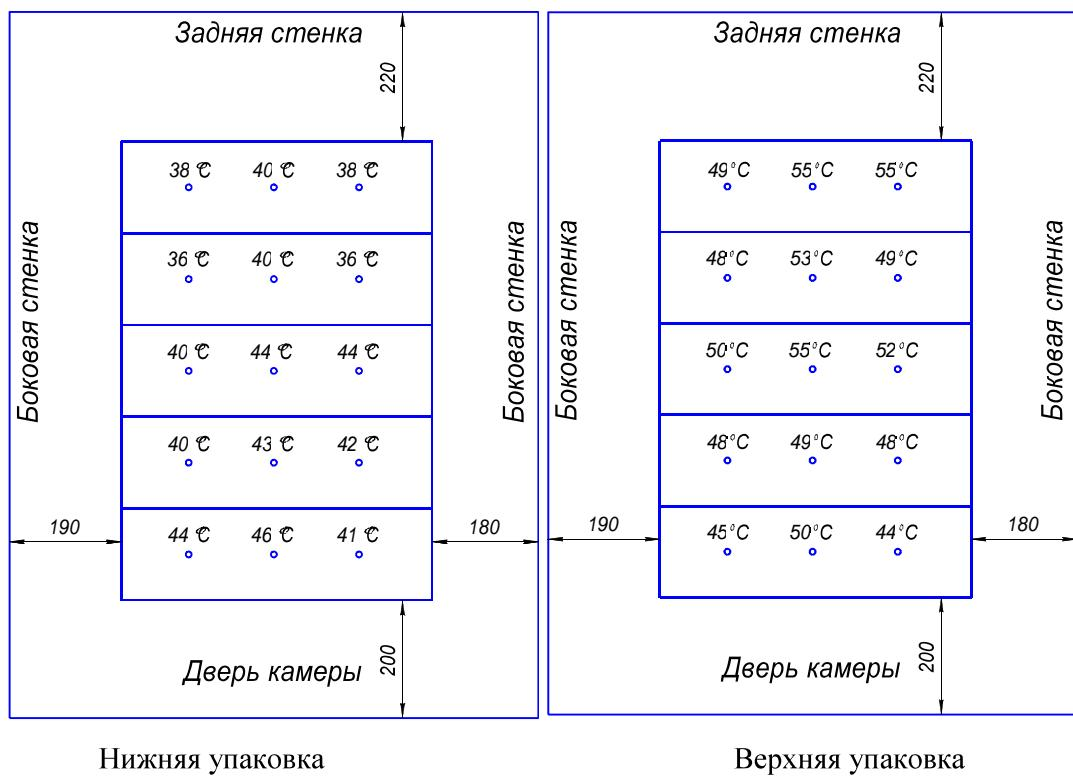
Рис.1. Результаты измерения температуры в упаковках одеял после термообработки в СВЧ камере.
