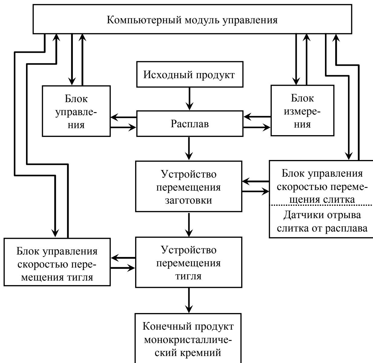
Рис. 1.30 Схема управления процессом вытягивания слитка
