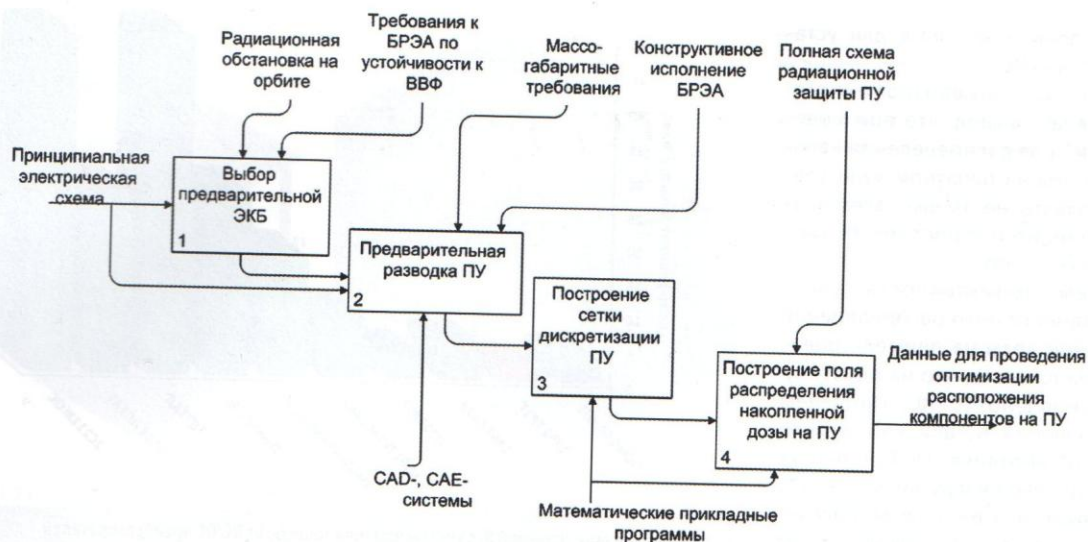
Рис. 8. Функциональная модель метода теневой защиты (БРЗА — бортовая радиоэлектронная аппаратура; ПУ — печатный узел)
