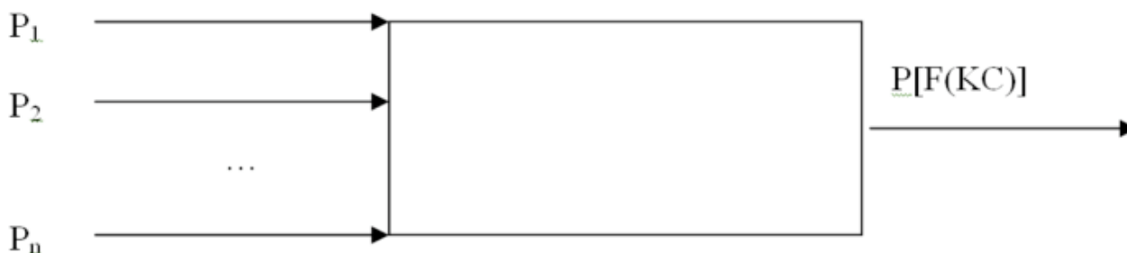
Рис. 9.3. Обобщенная схема математической модели, характеризующей безотказность функционирования КС
