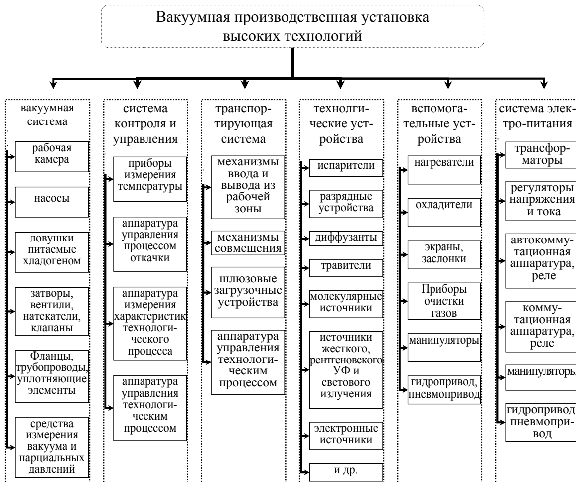
Рис. 1. Состав вакуумной производственной установки высоких технологий.
