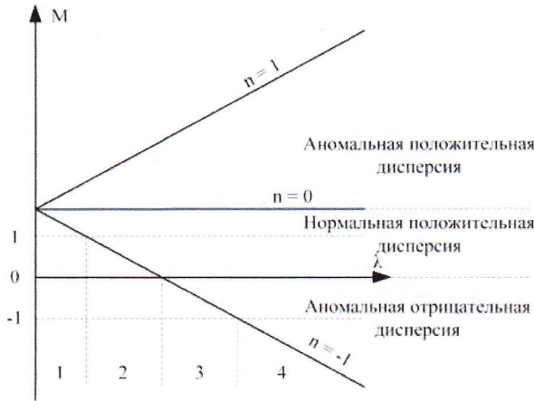
Рис. 3. Качественная зависимость коэффициента замедления M от длины волны для разных пространственных гармоник
