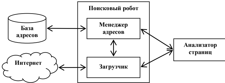
Рис. 2. Архитектура поискового робота
