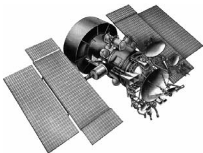
Рис. 4.1. Конструкция геостационарного КА «Горизонт»
