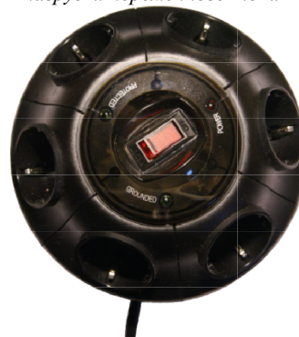
Макет «интеллектуального актуатора силовой нагрузки переменного тока», встроенный в корпус бытового удлинителья
