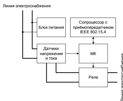
Блок-схема узла автоматизированной системы диагностики сети электроснабжения низких напряжений
