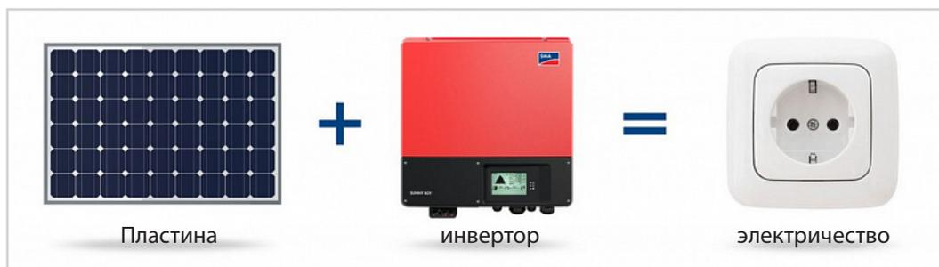
Рис. 1. Традиционная схема подключения солнечной электростанции.
