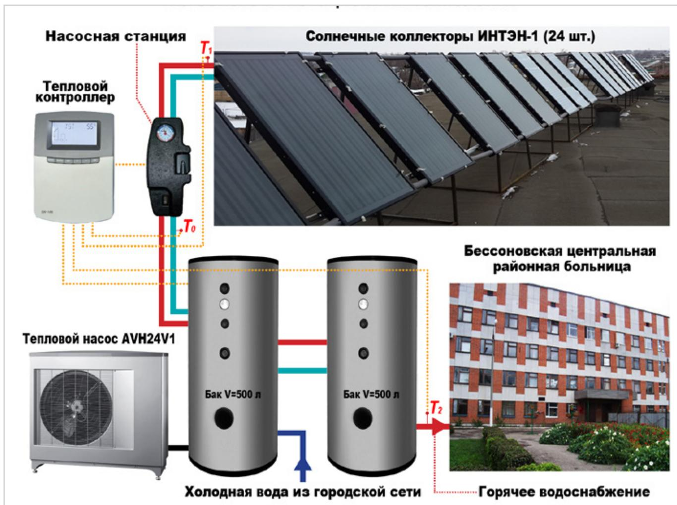
Рис. 4. Усовершенствованная схема ГВС ЦРБ с. Бессоновка.
