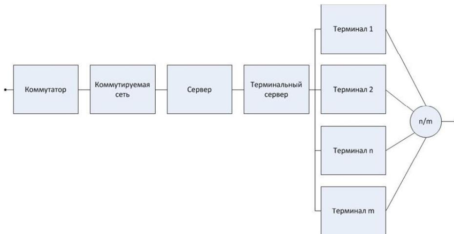
Рис. 4. Структурная схема надежности ЛВС на базе тонкого клиента
