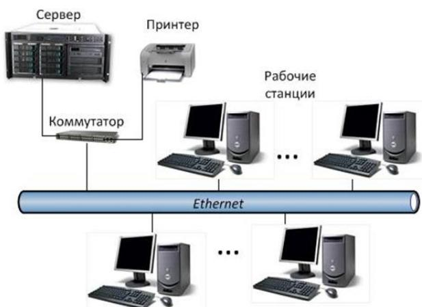
Рис. 1. Схема соединения устройств в ЛВС на базе PC
