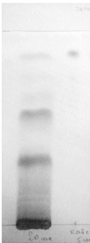
РИС. 1. Хроматограмма спиртового извлечения из корневищ и корней лапчатки белой и раствора СО (+)-катехина
