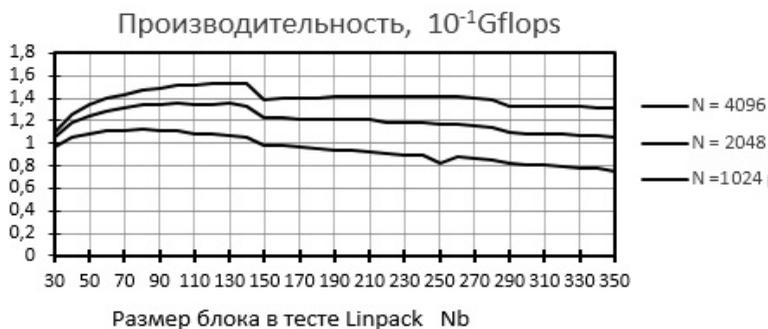
**Рис. 4. Производительность векторного сопроцессора на тесте Linpack при различных размерностях задачи**
