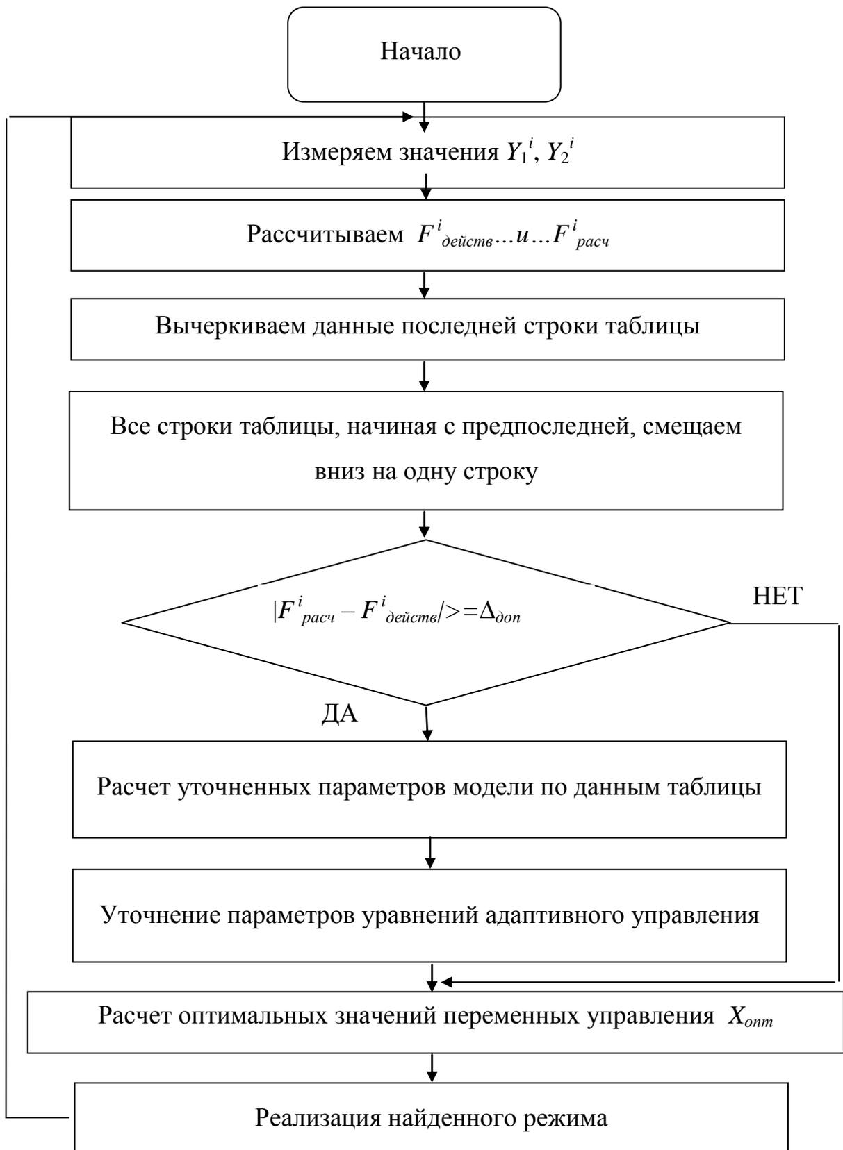
**Рис.3.1.1.** Алгоритм адаптивного управления качеством с подстройкой параметров модели
