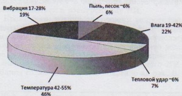
Рис. 1. Распределение отказов ЭС по видам воздействий
