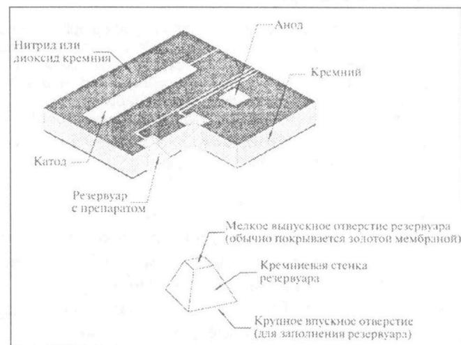
Рис. 2. Прототип устройства на микрочипе, выделяющего лекарственные препараты
