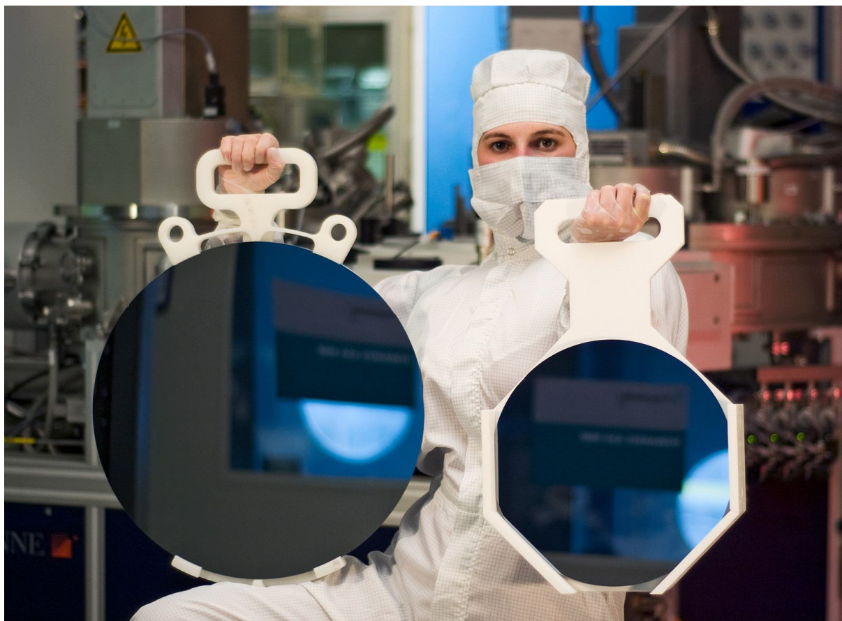
Рис. 6.2. Сравнительные размеры монокристаллических кремниевых пластин диаметров 450 мм и 300 мм [261]
