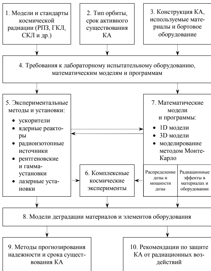
Рис. 5.70. Схема организации исследований воздействия космической радиации
