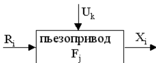
Рис. 4.18. Обобщённая модель пьезопривода:
